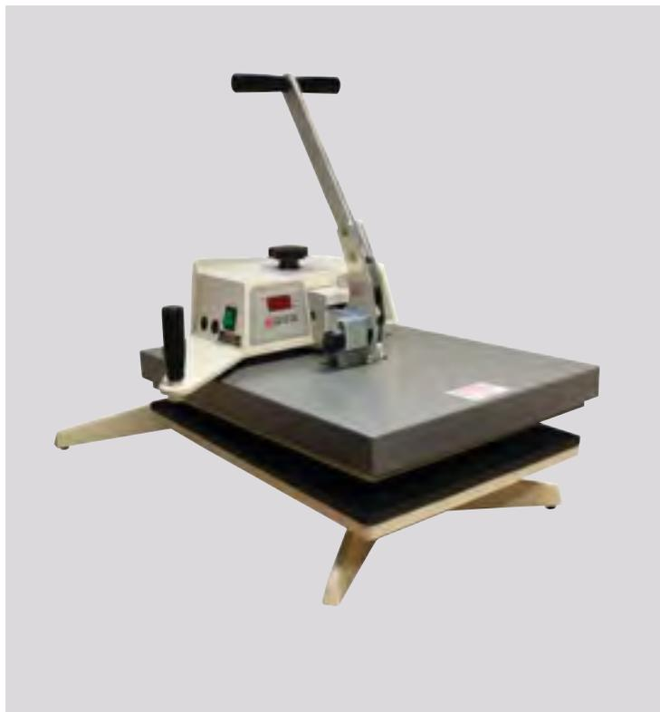
Presse à chaud manuelle à ouverture latérale. La plaque supérieure n'est pas fixée de manière rigide pour assurer une pression homogène entre la plaque supérieure et la plaque inférieure. Régulation électronique du temps et de la température. Sous plaque interchangeable avec vissage rapide. Convient à tout type d'application.
