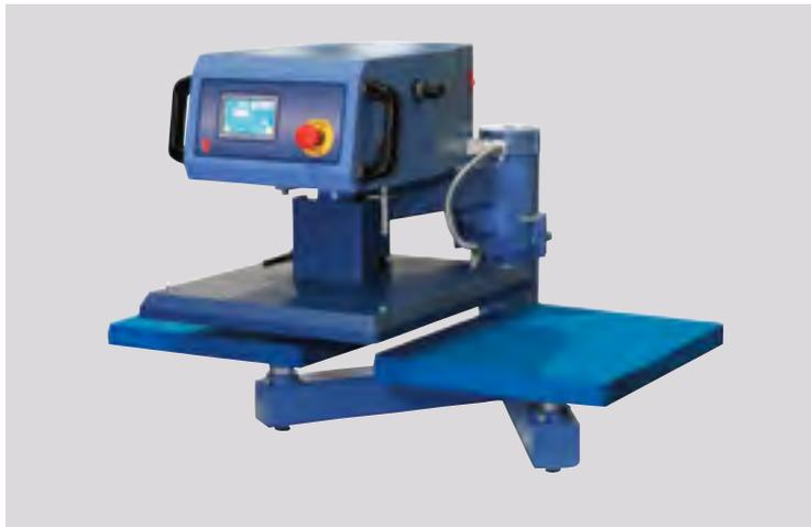
Presse à chaleur pneumatique avec double plaques chauffantes de 40x50, équipée d'une sécurité pour les mains.
