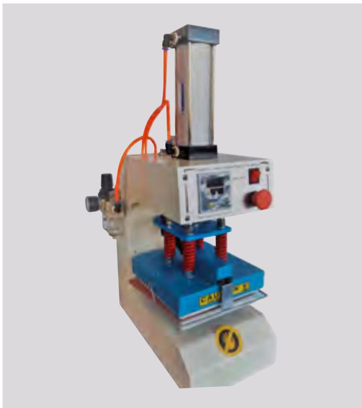
Presse pneumatique de transfert de chaleur pour le transfert et la sublimation de petites surfaces. Contrôle thermostatique numérique. Activation par pédale. A besoin d'un petit compresseur.
