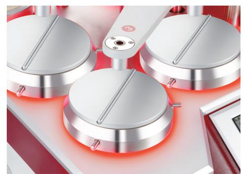
Abrasion des bords: cols de chemise, poignets, sangles de sac à dos et articles connexes
