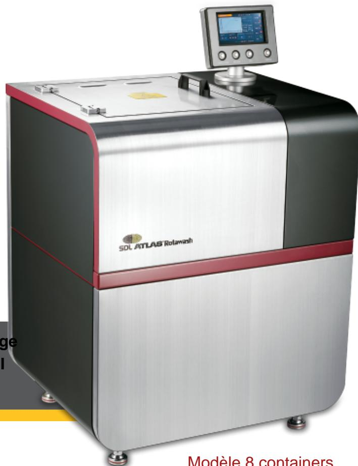
**Pour déterminer la solidité des couleurs au lavage ou au nettoyage à sec selon les normes ISO, BSI et AATCC pour les petites capacités**
